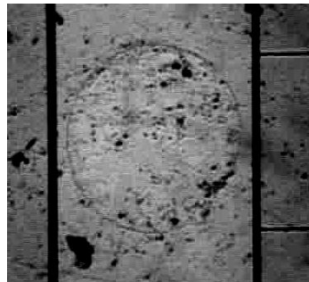
a) imagen (100x) de zona de impacto con una esfera de \phi 15.9 mm lanzada desde 130
