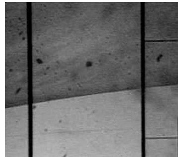
b) imagen (100x) de zona de impacto con una esfera de \phi 15.9 mm lanzada desde 200
