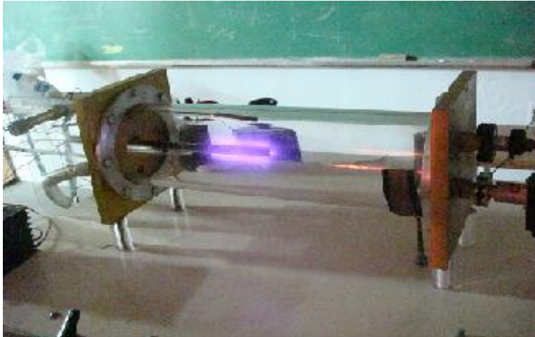
Reactor de plasma PECVD de descarga continua
